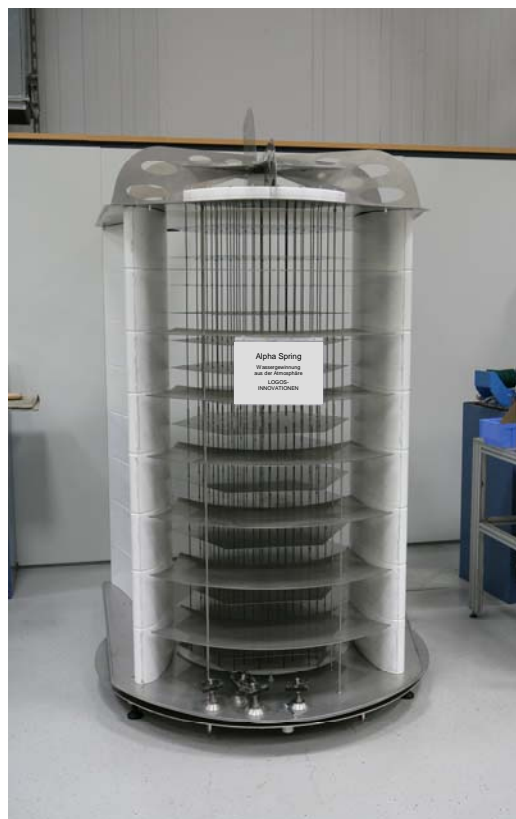
Technikumsanlage mit Alpha Spring Technologie (geplante Inbetriebnahme im Frühjahr 2011)
